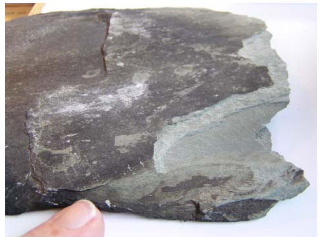
Naturskifertag - ægte grøn skifer fra omkring 1900. Man ser at denne skifersten er delamineret i sin lagdeling.
